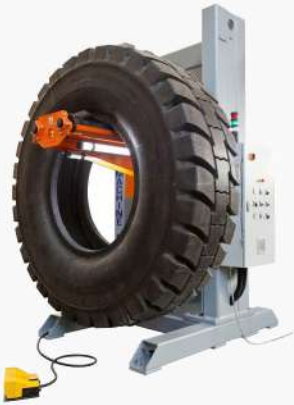
Inspection stand OTR
